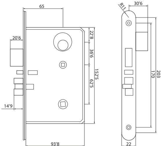
El pestillo anti fricción reduce la zona de contacto y el pestillo anti tarjeta impide su apertura mediante esta técnica.
